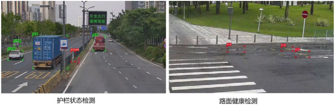
图 11-17 护栏状态监测和路面健康检测
