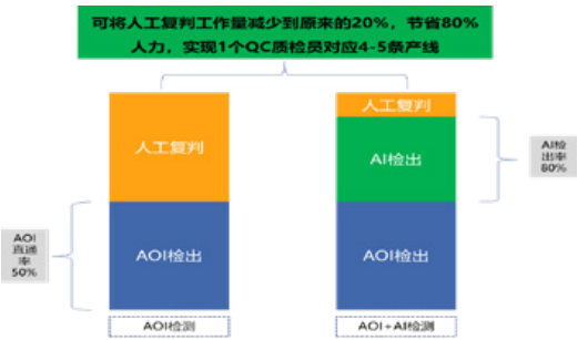
图 5-2 AOI+AI 检测效果对比
